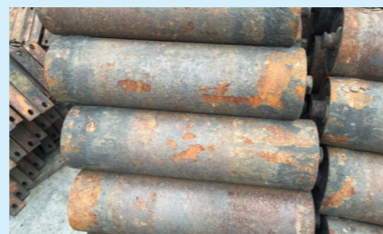
拆下备用的碳钢托辊
