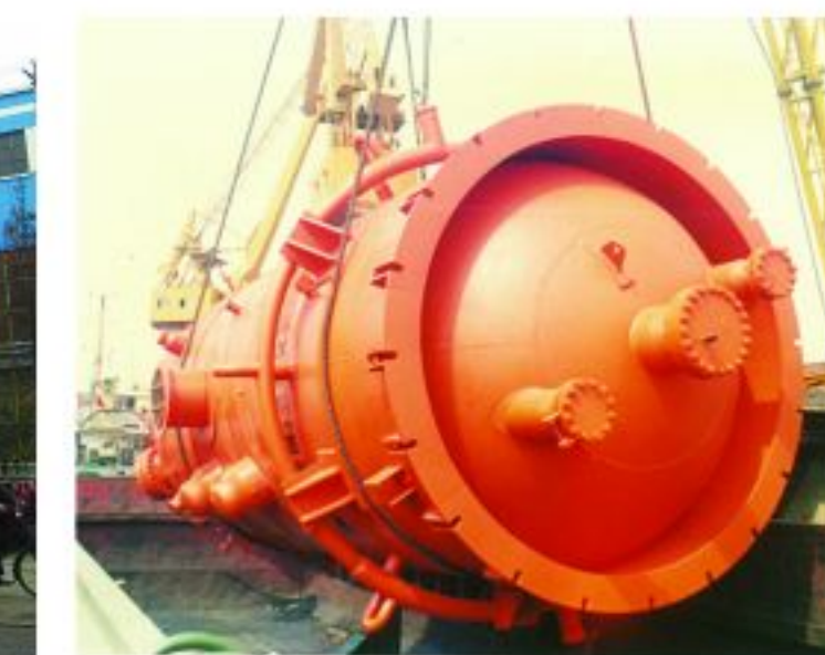
甲醇反应器 Methanol reactor
